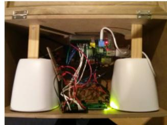
“Aus einem Raspberry Pi, einem LCD Display, einem Wlan-stick, PC Lautsprechern und 4 Knöpfen und 140 Zeilen Python-Code habe ich ein Web-Radio gebaut.”
