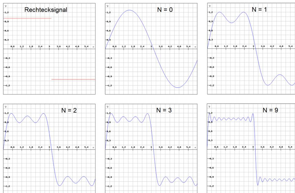
Abbildung 3: Rechtecksignal und die sukzessive Approximation durch die abgeschnittenen Fourier-Reihen mit  $N = 0$ ,  $N = 1$ ,  $N = 2$ ,  $N = 3$  und  $N = 9$ . An den Sprungstellen der ursprünglichen Funktion bei  $n\pi$  sind die approximierenden Funktionen stetig, die Unstetigkeiten ergeben sich erst im Limes.
