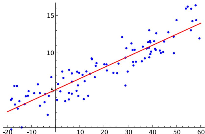
Realisiere Punkte  $(x_i, y_i)$  mit Nägeln, Gerade  $g$  mit beweglichem (aber starren) Stab. Verbinde jedes  $(x_i, y_i)$  mittels Gummibänder mit dem Stab. Loslassen. Stab pendelt sich auf Ausgleichsgerade ein.
