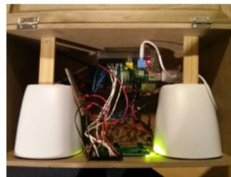
“Aus einem Raspberry Pi, einem LCD Display, einem Wlan-stick, PC Lautsprechern und 4 Knöpfen und 140 Zeilen Python-Code habe ich ein Web-Radio gebaut.”
