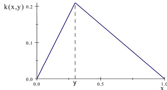
Die Greensche Funktion  $k(x, y) = \min(x, y) - xy$  als eine Funktion von  $x$
